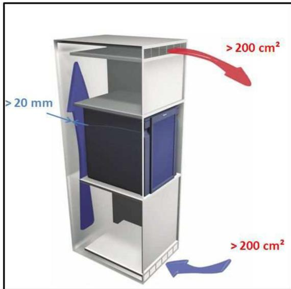
Um eine optimale Kühlleistung bei geringstem Energieverbrauch zu gewährleisten, müssen beim Einbau eines Absorberkühlschranks einige Vorschriften beachtet werden. Die Wärme, die der Kühlschrank dem Kühlinnenraum entzieht, gibt er über die Geräterückseite ab. Damit dort kein Wärmestau entsteht, muss für eine ausreichende Luftzirkulation gesorgt werden.
